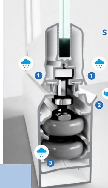
El sistema Balkon10 incluye 3 modos de evacuación de aguas, tanto de lluvia como aguas que se acumulan por la condensación producida al interior del hogar.
